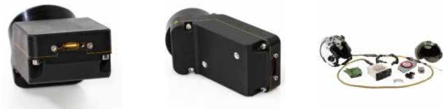
IS-1200+ HObiT经过工厂全面校准,易于使用。使用IS-1200+ HObiT提供的全新VisualMapper软件,可以在几分钟内安装基准星座并将其映射到约50微米的精度。安装后,传感器立即准备就绪,无需额外校准。为了在车辆上使用,自动协调算法支持系统将基准星座与车辆惯性导航系统或姿态进行参考自对准。
