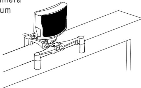
Stellen Sie nun mit dem schwenkbaren Kamerakopf den Blickwinkel ein.
