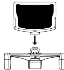
Befestigen Sie die Kamera an Ihrem Monitor. Justieren Sie die Kamera so, dass eine direkte Sicht zum TrackClip gegeben ist.
